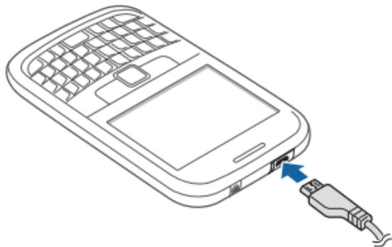
**!** Falsches Anschließen des Reiseadapters kann zu schweren Schäden am Telefon führen. Schäden durch unsachgemäße Verwendung sind nicht von der Garantie abgedeckt.
